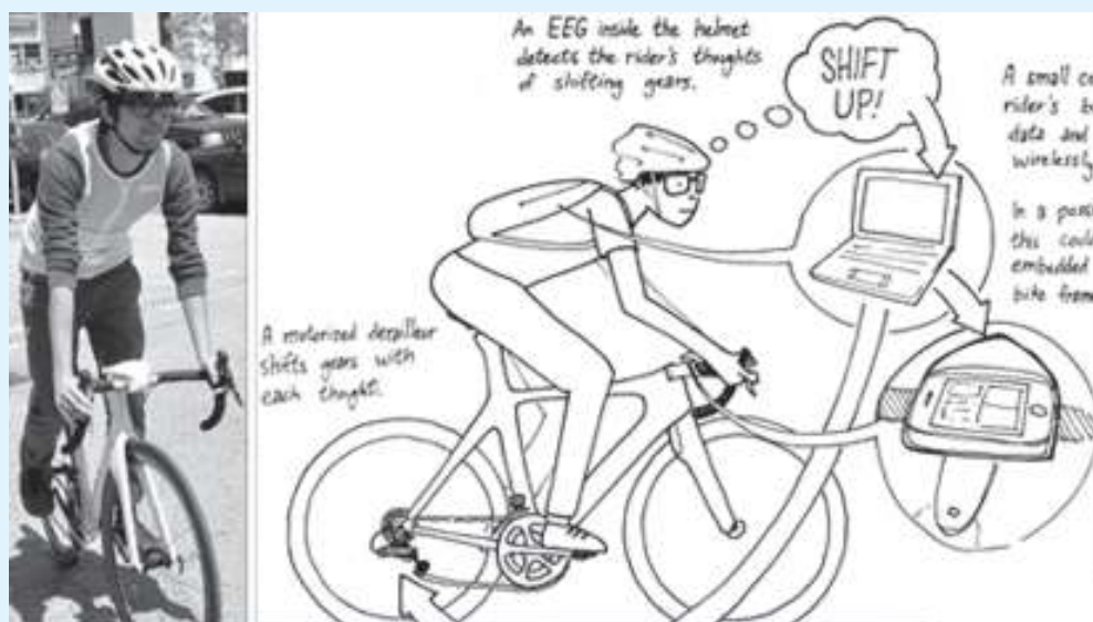
Xe đạp điều khiển bằng suy nghĩ có thể thay đổi hệ thống phụ kiện một cách dễ dàng thông qua ý nghĩ của người lái
