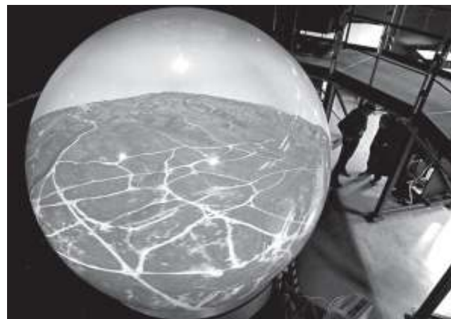
Quả cầu pha lê: Một dãy gồm 13 máy chiếu có độ phân giải cao chiếu thẳng vào mặt ngoài của quả cầu có đường kính 3,4m.
