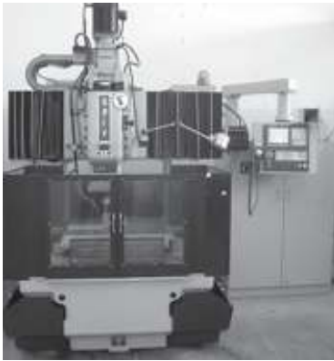
Máy chuyên dùng gia công tấm bằng biến dạng cục bộ liên tục (SPIF)
