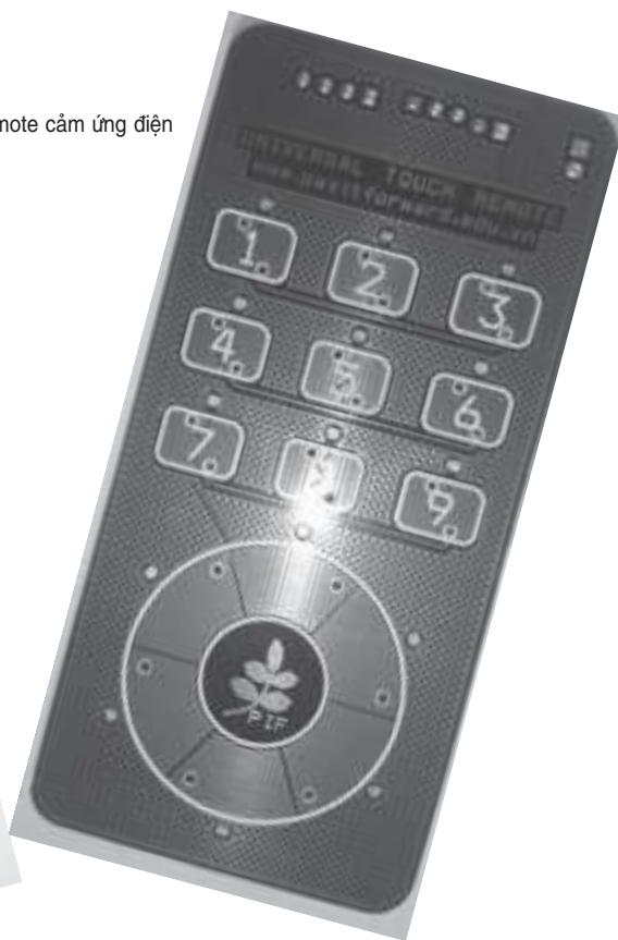
Mặt trước của Remote cảm ứng điện dung.
